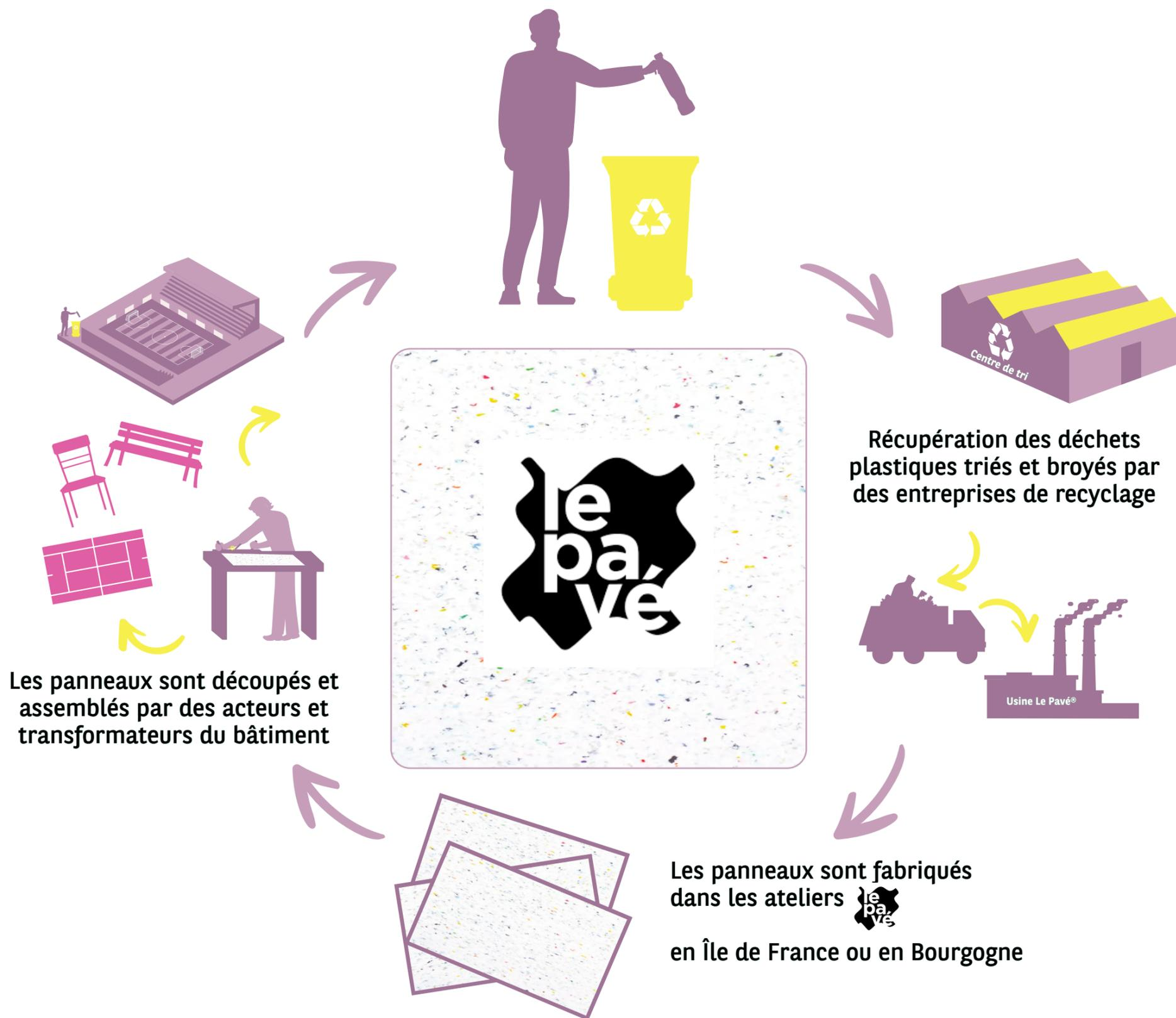
Les panneaux sont découpés et assemblés par des acteurs et transformateurs du bâtiment
